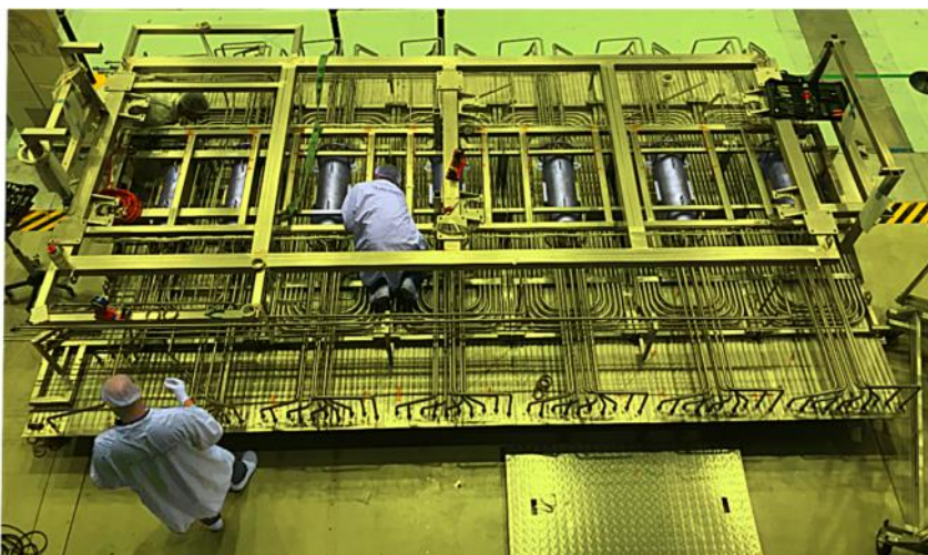
Figure 9 : Montage des panneaux rayonnants -1
