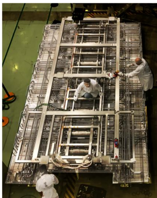
Figure 10 : Montage des panneaux rayonnants -2
